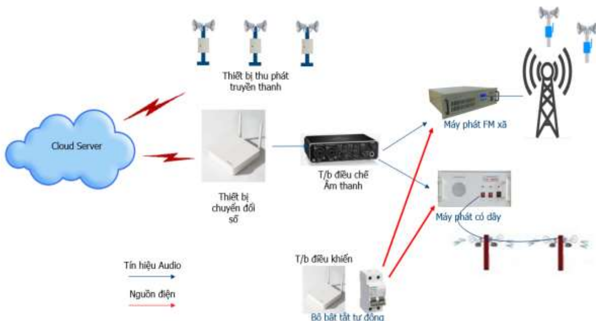
Hình 2: Mô hình tích hợp hệ thống truyền thanh ứng dụng CNTT-VT với các hệ thống truyền thanh truyền thống.
